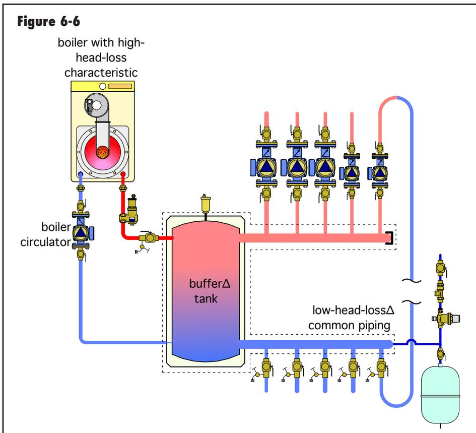
**HYDRAULIC SEPARATION USING A BUFFER TANK:**
